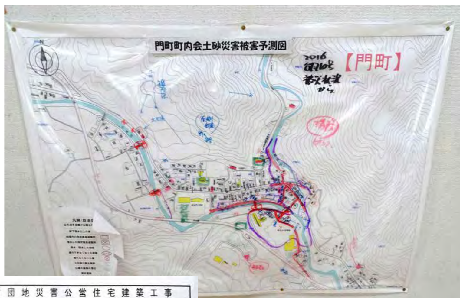
門町地区の2016年台風10号被災状況地図、流されて改修が必要な生活橋がプロットされている
